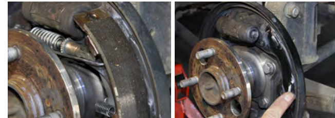
ドラムブレーキ装置のメンテナンス バックプレートとシューの当り面
