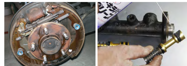
ドラムブレーキ装置のメンテナンス ブレーキマスターシリンダーのメンテナンス
