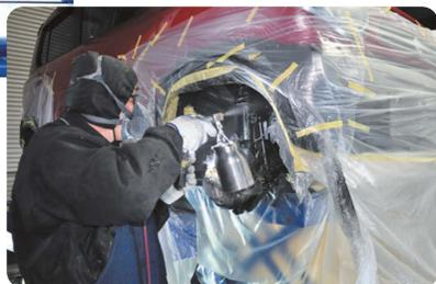
足回りや溶接跡などのサビが発生しやすい部分は重点的に、タイヤハウス内やホイールアーチなど塗りにくい箇所にもきっちり施工。車を知りつくしたプロの丁寧な施工で下回りの防サビコートを完成させます。
