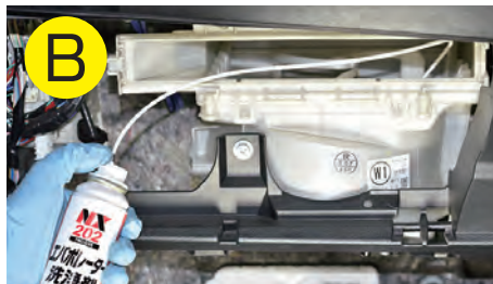
B ブロアファンの間隙から注入
