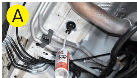
A 車体下部排水ドレンより注入
